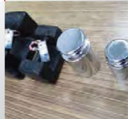
ตู่้นน้ำหนักมาตรฐาน Standard Weight ใช้สำหรับทวนสอบเครื่องชั่ง ก่อนใช้งาน
