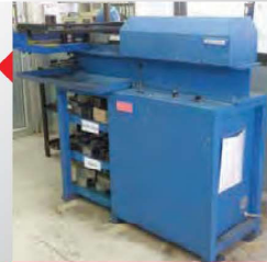
เครื่องทดสอบค่าแรงดึง Universal Testing Machine (Max. Load 120 Tons)
