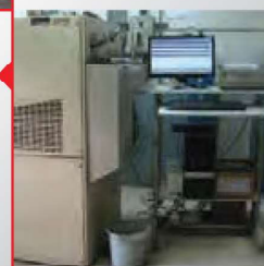
เครื่องวิเคราะห์ ส่วนประกอบทางเคมี Optical Emission Spectrometer
